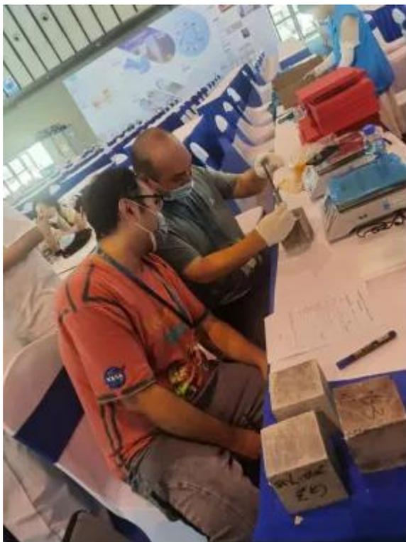
中建西部建设贵州有限公司技术中心三人代表公司参加了比赛。经过八个多月精心筹备，经过数十次实验，不断摸索试配方案，自主设计制作高强轻质骨料，最终研发出体积密度小于  $1350\text{kg}/\text{m}^3$ ，抗压强度大于  $80\text{MPa}$  的混凝土材料。经综合大赛现场答辩与试件性能测
